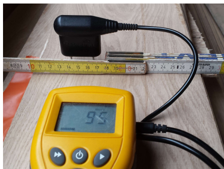
Afbeelding 1: Elektronische meting, merk op: mooi binnen de grenzen, tussen 8 – 12 %
