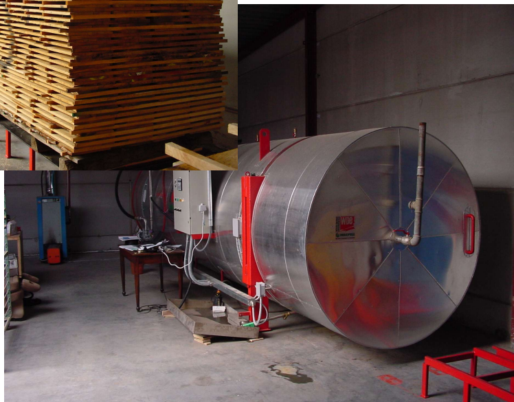
Afbeelding 11: Boven: gestickerd hout, klaar om te worden gedroogd; Onder: WDE Maspell Roll 6 vacuümdroogoven in werking.
